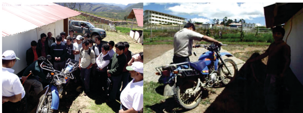
Figura 107. Motocicleta Yamaha de 200 cc funcionando a biogás en la UNTRM.
