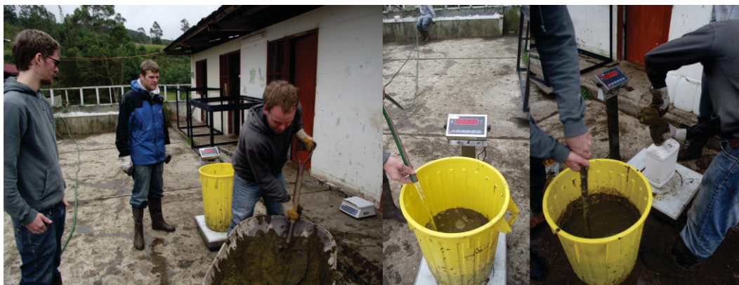
Figura 15. Preparación de la mezcla estiércol:agua.
