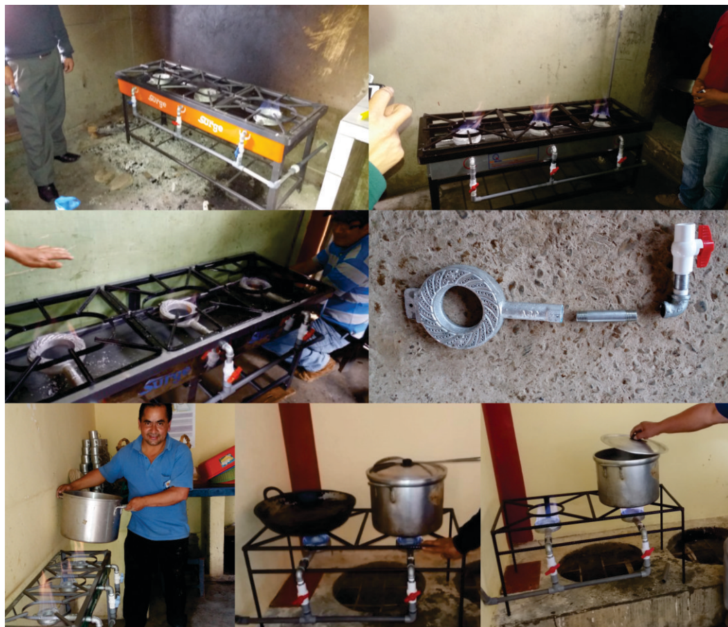
Figura 99. Cocinas industriales habilitadas para funcionar a biogás en reemplazo de cocinas a leña, para mejorar la calidad de vida en zona rural.
