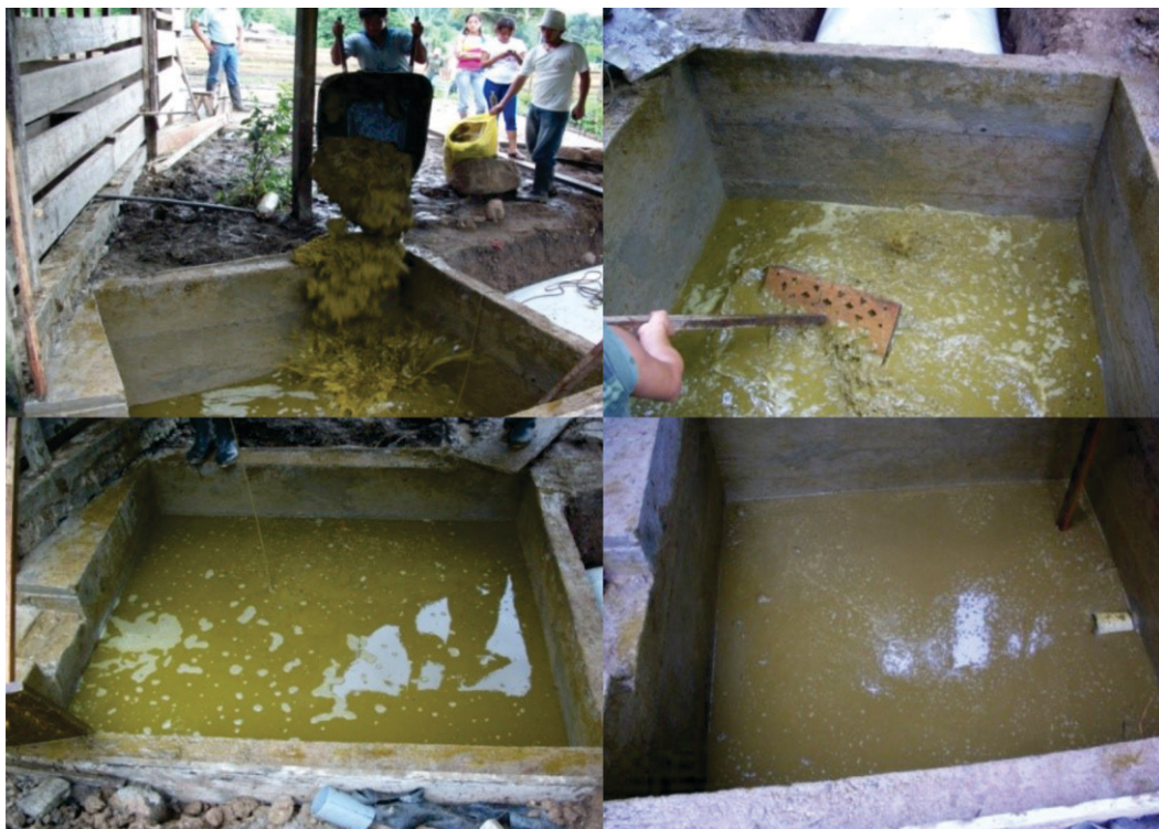
Figura 69. Secuencia para preparar la mezcla estiércol:agua (1:5) para alimentar el biodigestor.
