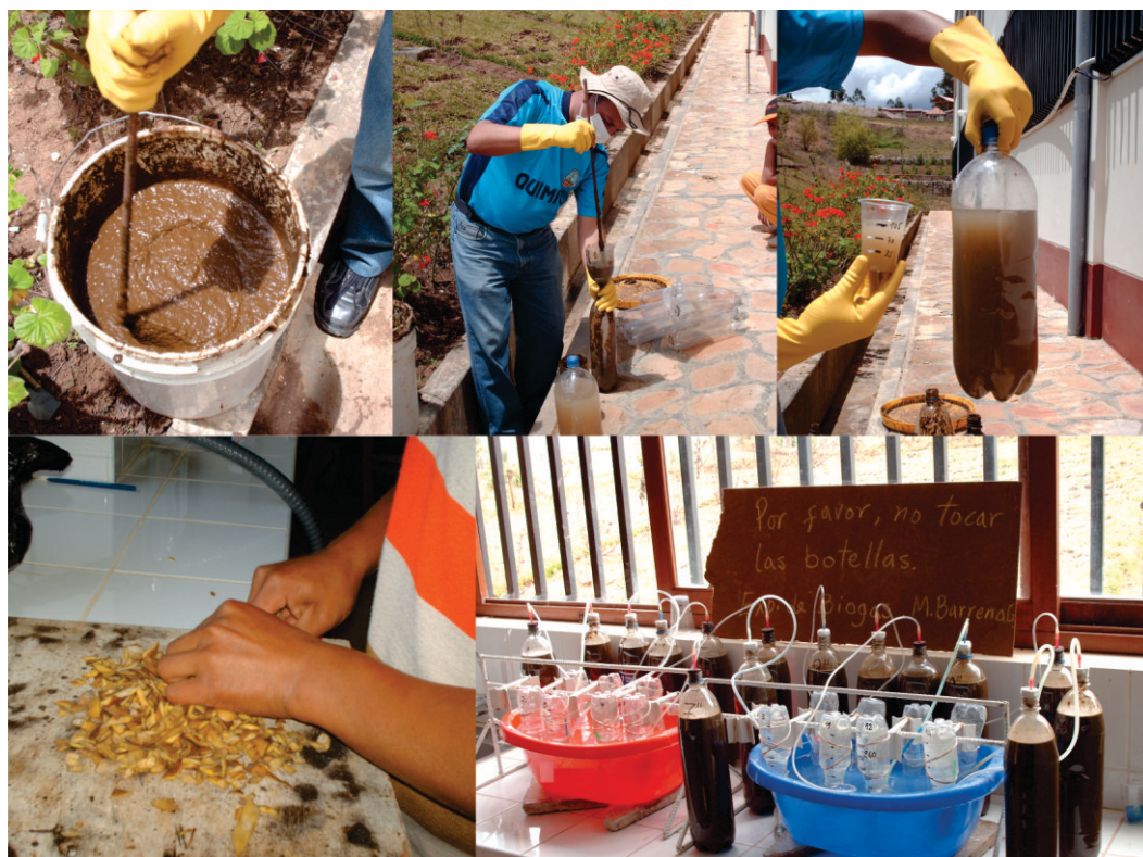
Figura 10. Dosificación del estiércol, agua de desagüe y cáscara de papa. Bidigestores conectados a su botella de colección de biogás.
