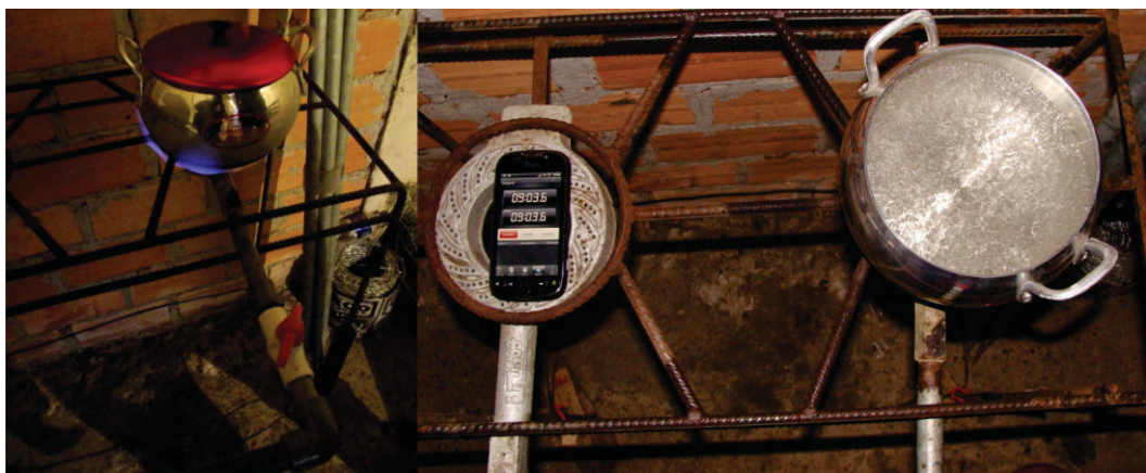
Figura 91. Un litro de agua hierve en 9 minutos en la cocina a biogás de Pomacochas.
