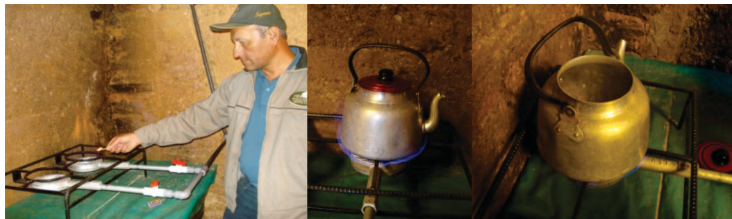
Figura 87. Primera prueba de la cocina a biogás en Santo Tomás. 4 L de agua hirvieron en 18 minutos.
