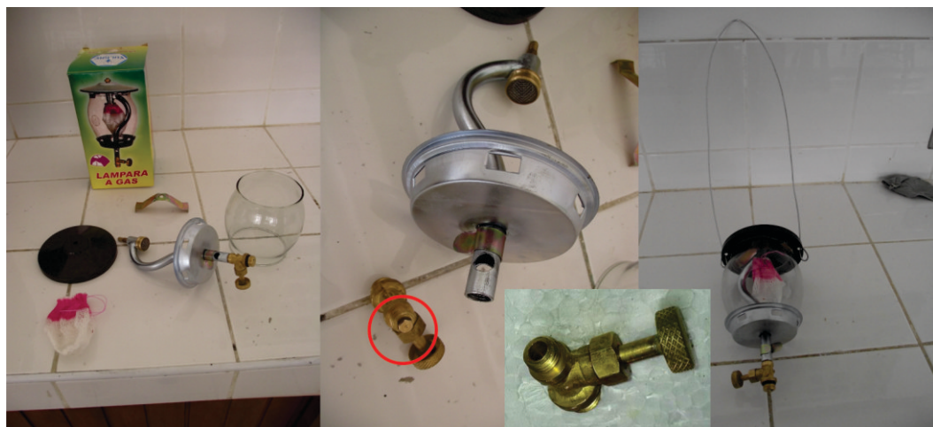
Figura 101. Lámpara adaptada para funcionar a biogás.
