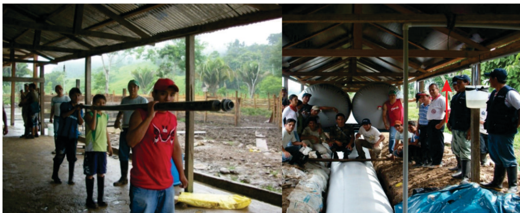
Figura 72. Cartucho para eliminar el H 2 S del biogás.
