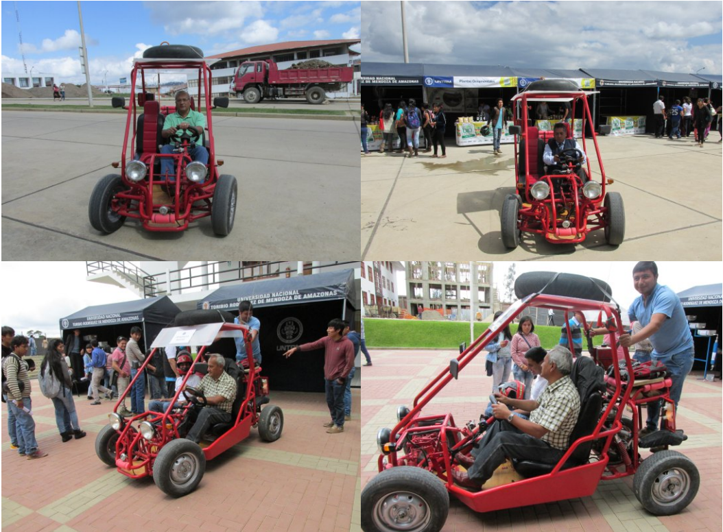
Figura 128. Pruebas de manejo del \beta -150 a biogás.
