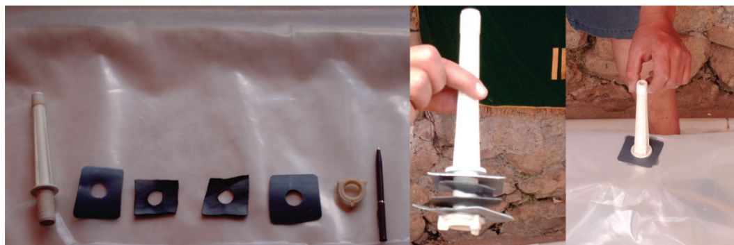
Figura 34. Accesorio de plástico con rosca de \frac{1}{2} ", placas de PVC, empaquetaduras de jebe y tuerca de plástico. Se colocó en el centro del biodigestor para salida del biogás.
