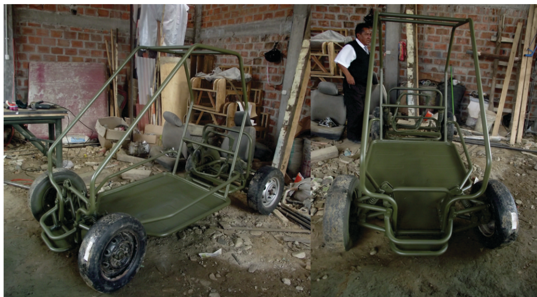
Figura 119. Construcción del mini automóvil.
