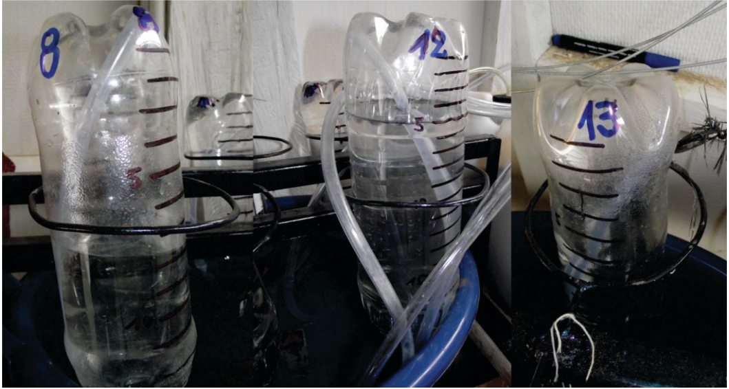
Figura 18. Botellas colectoras de biogás de los biodigestores 8, 12 y 13.
