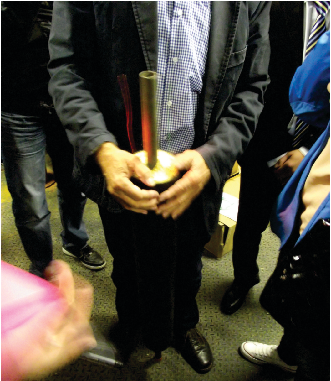
Figura 157. Tubería de hierro galvanizado, aislada con poliuretano, para conducir el agua caliente a Jühnde para calefacción.
