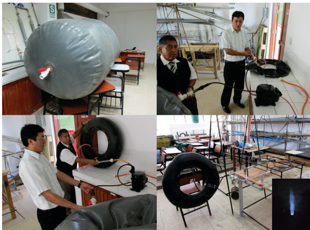
Figura 125. Balón con biogás, inicio y fin del trasvase de biogás a la cámara, prueba de combustión del biogás en la cocina.
