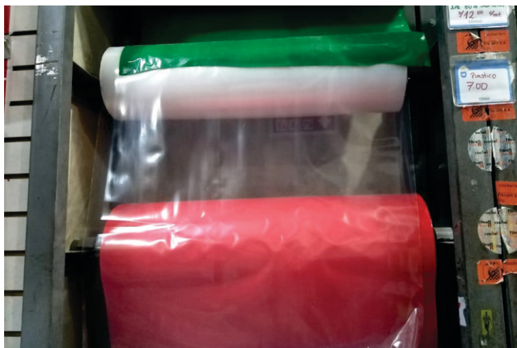
Figura 30. Rollos de manga de polietileno de diferentes colores.
