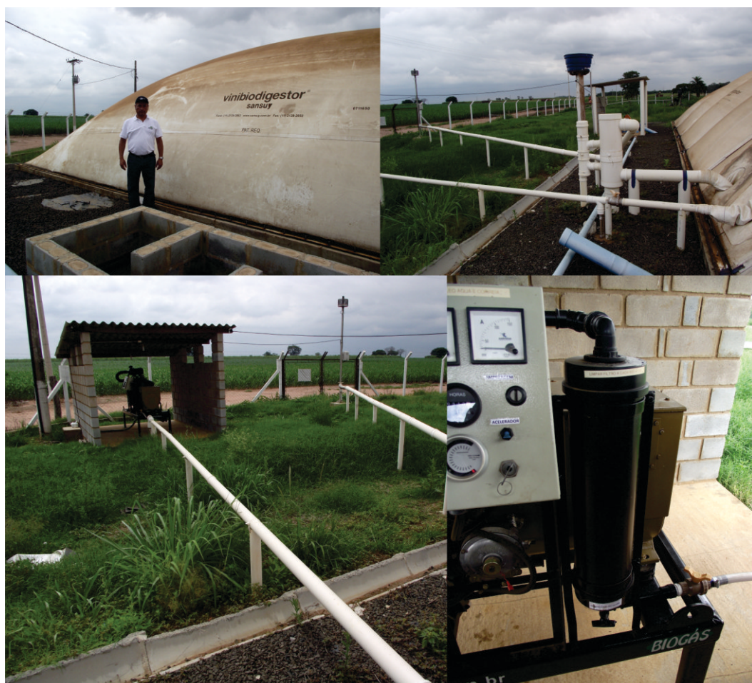
Figura 113. Biodigestor que abastece al motor Ford de 6 cilindros a biogás acoplado a generador eléctrico de la granja de cerdos de la Hacienda de la FAYS en Pirassununga.
