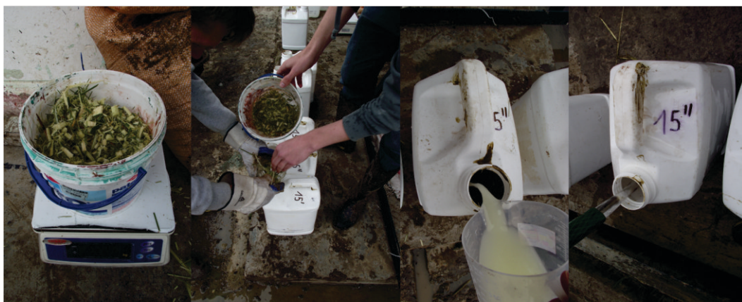
Figura 16. Dosificación de los chips de totora y del suero de leche. Se completó el volumen de la mezcla experimental a 10 L con agua reposada.
