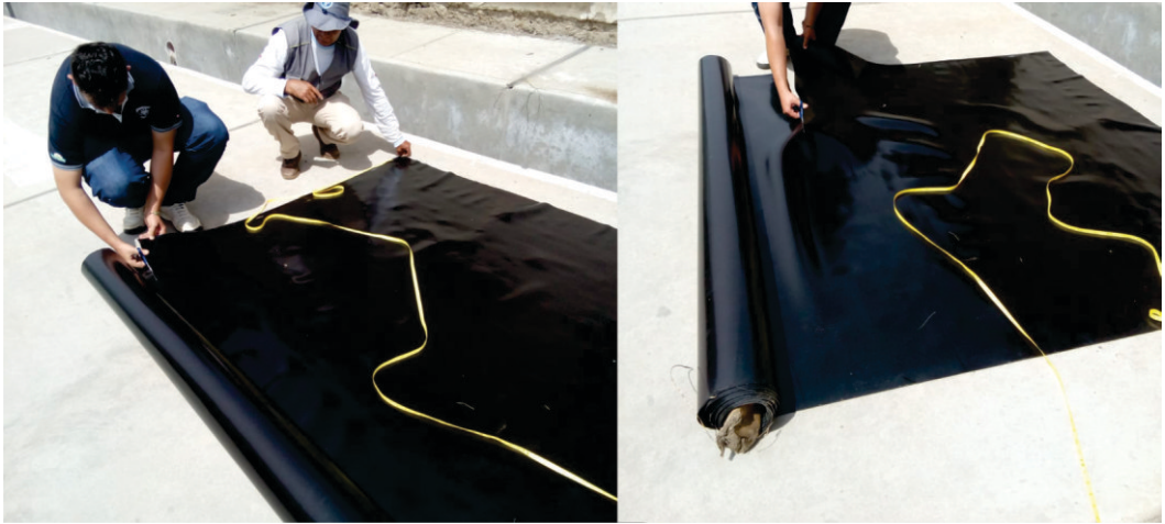
Figura 31. Rollo de geomembrana de PVC.
