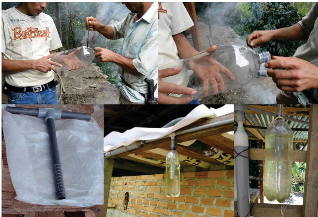
Figura 73. Regulador de presión o válvula de seguridad del sistema.
