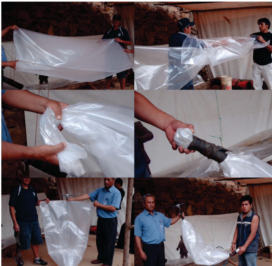
Figura 39. Secuencia de armado del balón para almacenar el biogás.
