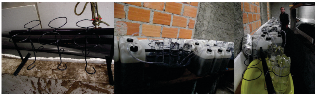
Figura 17. Soporte de las botellas colectoras de biogás y equipos experimentales instalados por el Ingeniero Agrónomo Thies Fellenberg.
