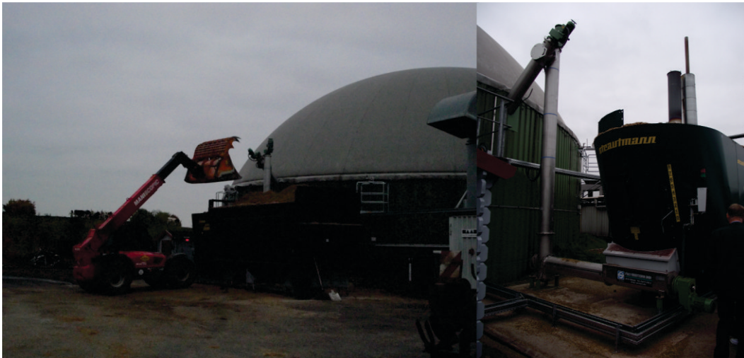
Figura 144. Carga de ensilado al contenedor-balanza de alimentación del fermentador de Jühnde. Tornillos sin fin transportan el ensilado al interior del fermentador.
