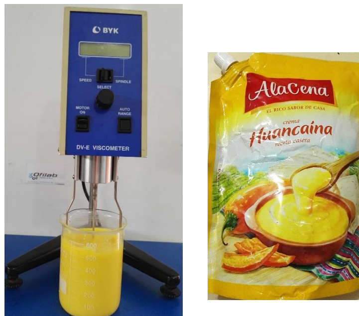
Figura 10 Viscosímetro BYK RV –DV- E versión 1 y Huancaína Alacena
