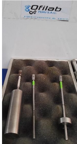
Figura 5 Tipos de Spindle – Viscosímetro rotacional Broofield
