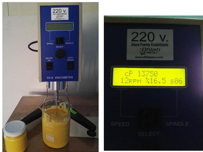
Figura 12 Viscosímetro BYK RV-DV –E versión 1 y salsa tarwi
