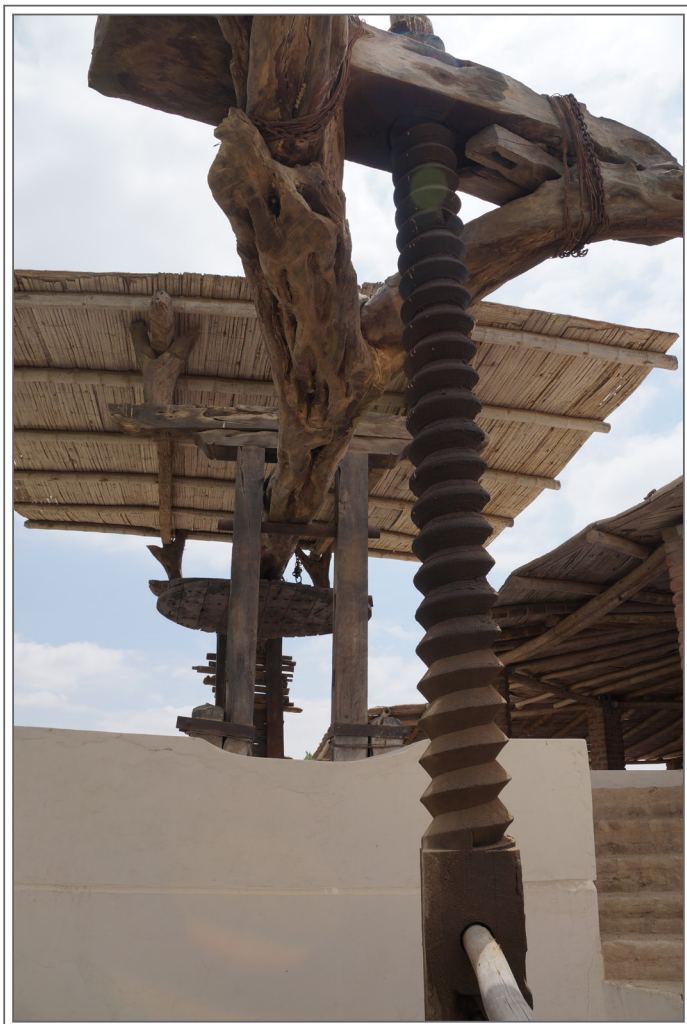
Figura 79. Prensa de palo típico de la costa peruana, fabricada de huarango, utilizada para el proceso de obtención del mosto. Foto: JNF / La Caravedo, Ica.
