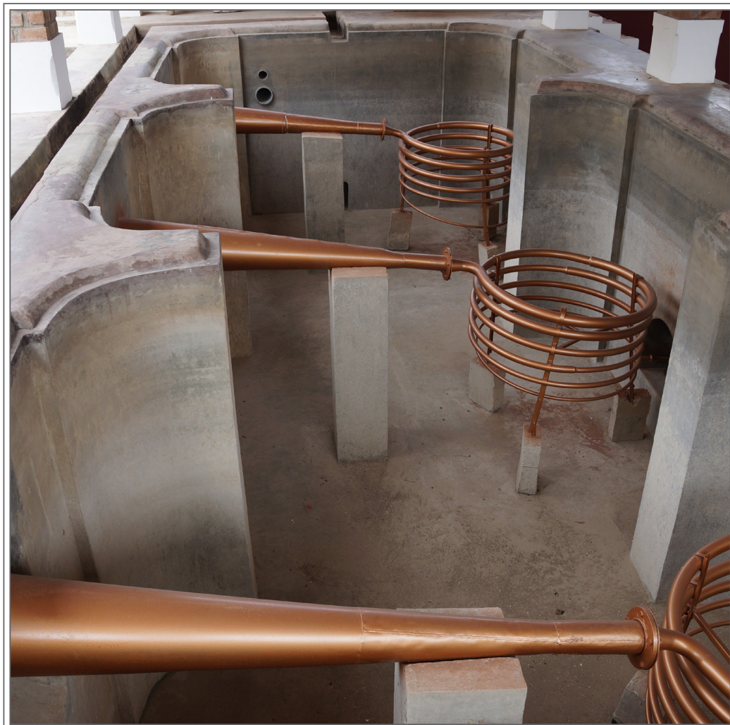
Figura 82. Proceso de destilación en alambiques de cobre en la bodega La Caravedo. Foto: JNF / La Caravedo, Ica.
