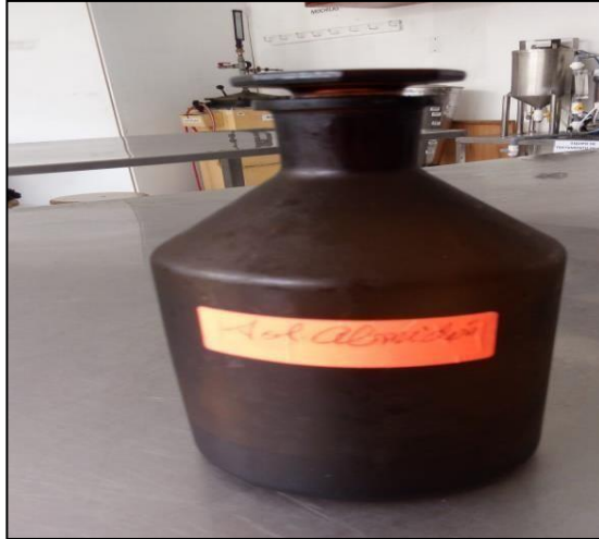
Preparación de la Solución de almidón soluble (indicador)
