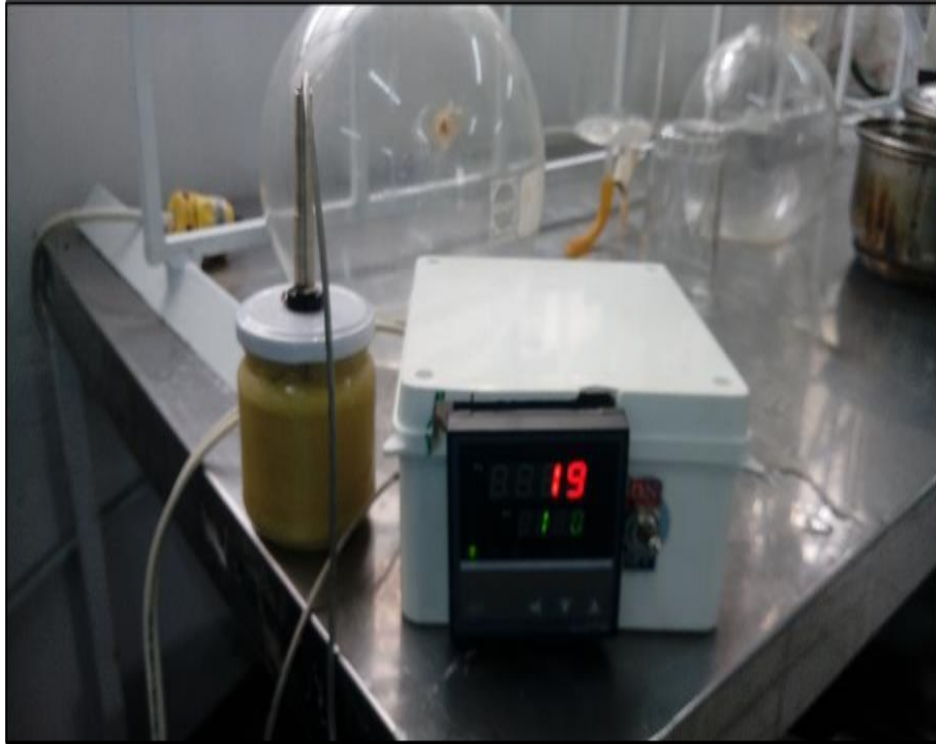
Sensor en el punto mas frio del envase para determinar curvas de calor
