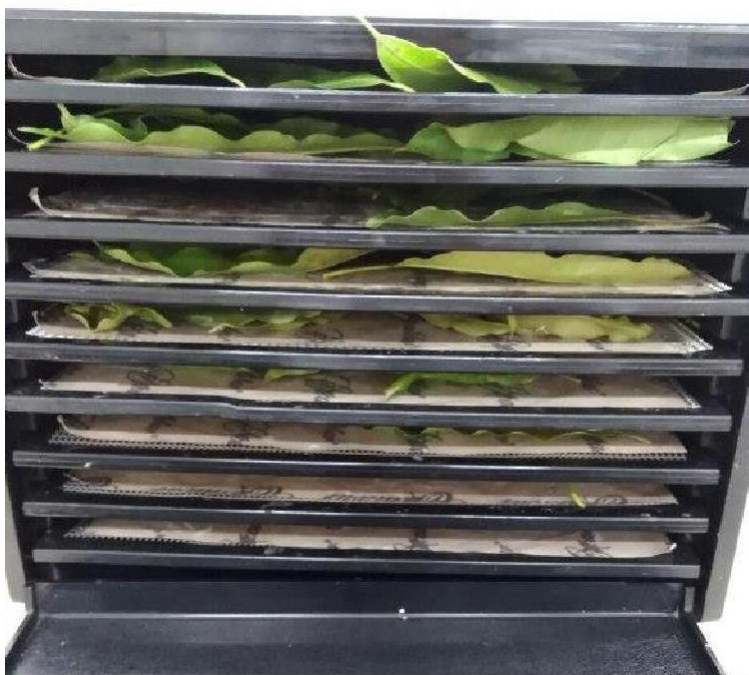
Figura 8. Secado de hojas de mango a 45\pm 2^{\circ}\text{C} por 48 horas
