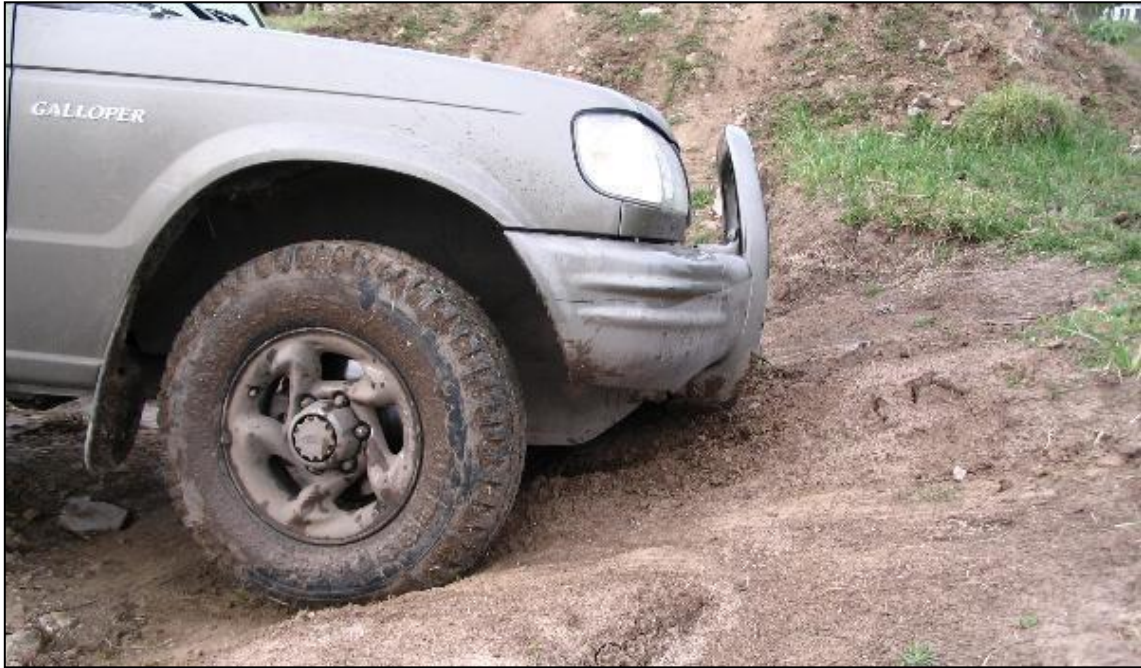
Figura 38. Accidente con el ángulo de ataque Fuente: https://www.parque4x4.com.ar/articulos/angulos/index.html
