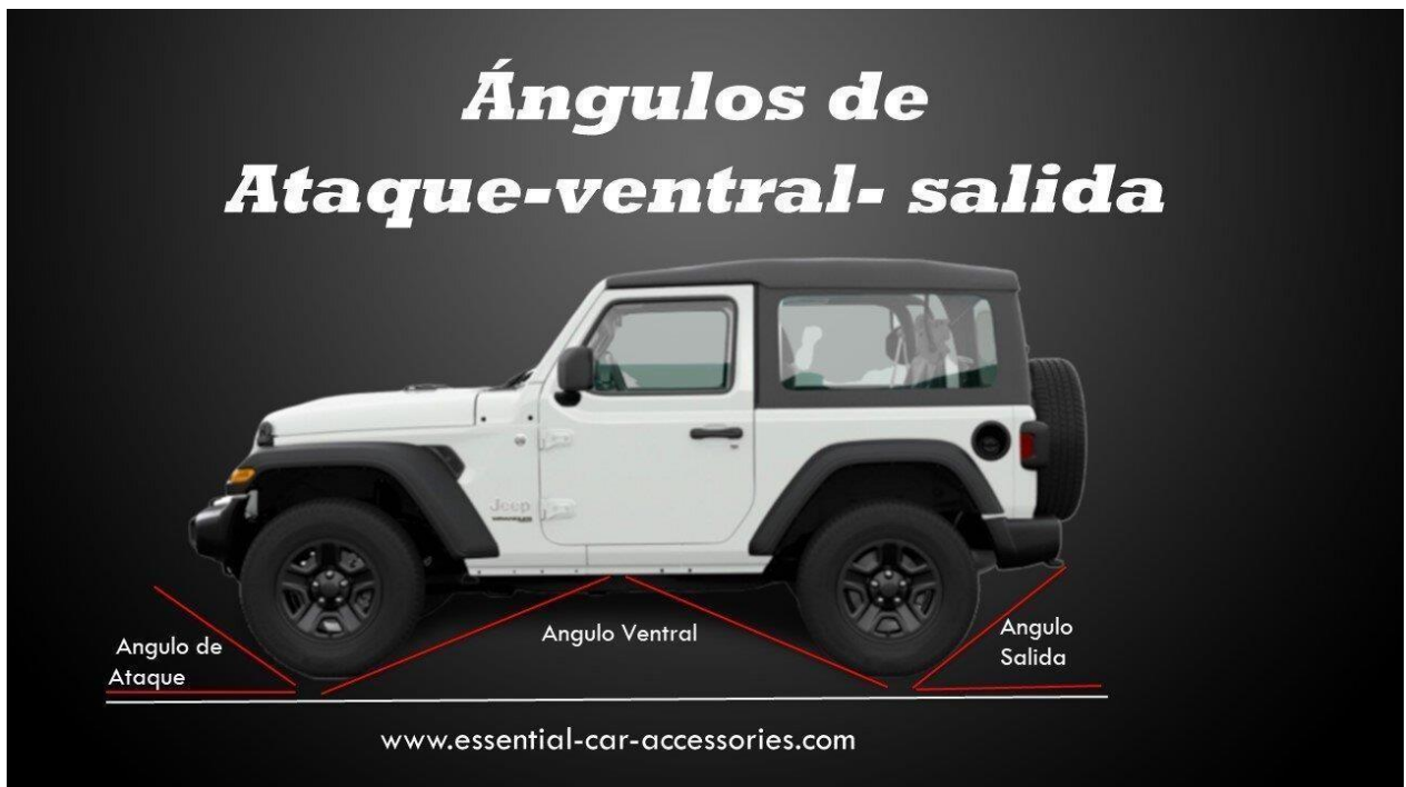
Figura 37. Ángulos de un vehículo arenero. Fuente: www.essential-car-accessories.com
