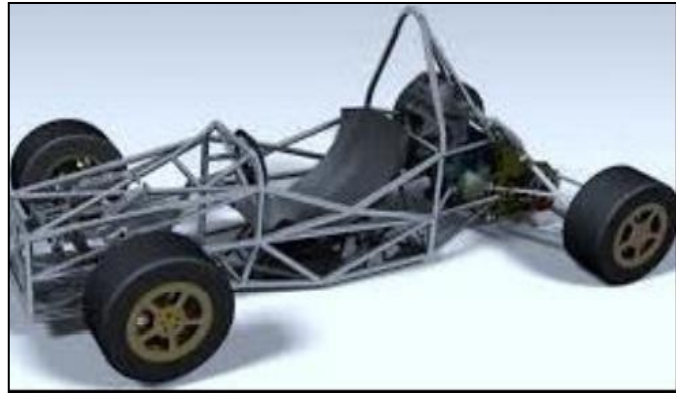
Diseño de estructura tipo Formula SAE Fuente: Adanaque, A. y Flores, G (2019)
