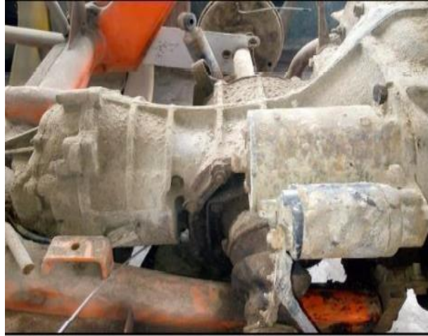
Transmisión del vehículo Volkswagen Beetle modelo 1300 Fuente: Adanaque, A. y Flores, G (2019)
